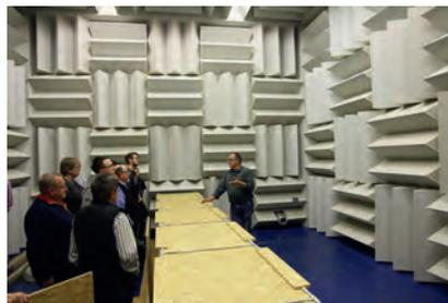
Das Schalllabor: Bis zu 99 % wird hier der Schall absorbiert. Der Versuch mit den Holzpressplatten soll eine Straßenschlucht simulieren.
